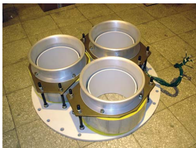
GIS CT 安裝 GIS CT installation
